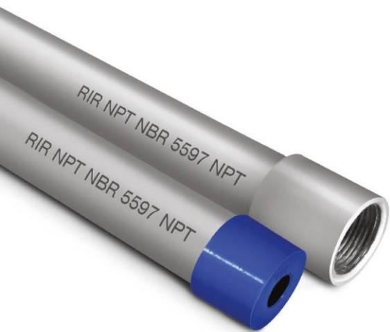
Eletroduto RIR rígido fabricado em aço carbono com rebarba interna removida, fornecido com uma luva e protetor de rosca, barras com 3000mm e acabamento galvanizado a fogo / imersão a quente.
