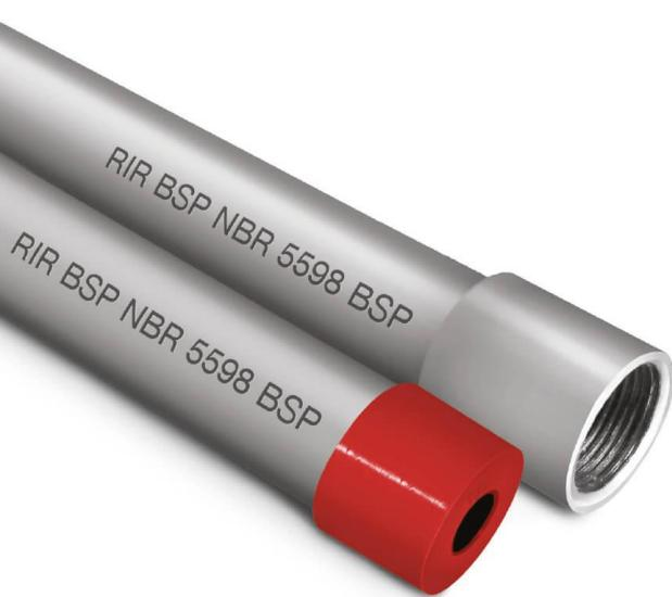
Eletroduto RIR rígido fabricado em aço carbono com rebarba interna removida, fornecido com uma luva e protetor de rosca, barras com 3000mm e acabamento galvanizado a fogo / imersão a quente.
